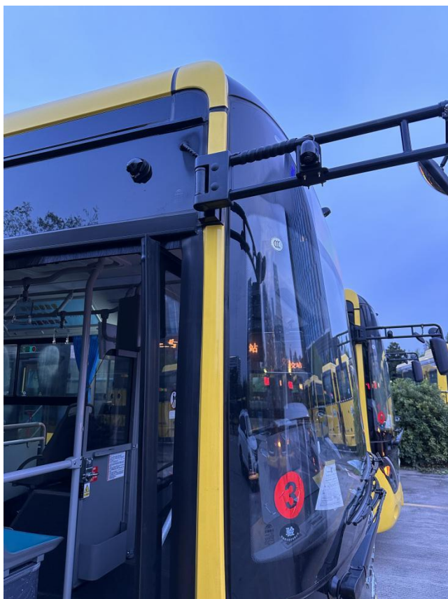
摄像头安装位置
